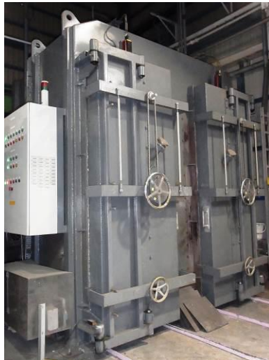
進行氰化合物分解處理的鍋爐外觀
