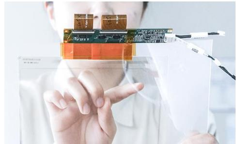
近年來隨著穿戴式裝置等顯示器愈加多樣化，用於觸控面板感應器等基板的電子電路印刷對軟性基板的需求也越來越高。雖然過去期望開發出具備最低電阻值的可印刷金屬網配線，但因金屬部分幾乎不透光，故必須以肉眼無法觀察的電子電路分佈線寬—微米為單位進行細微加工。而現在我們可藉由使用通透性高、電阻值低、最適用於電路印刷的材料—銀奈米墨水，發展出細微金屬網圖案的導電性薄膜，且可望進一步運用於包含穿戴式裝置在內的多種用途。
