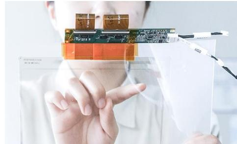
터치패널 센서 등에 사용되는 기판에의 전자회로 인쇄는 최근 웨어러블 디바이스 등의 디스플레이 다양화에 따라 플렉시블한 기판에 대한 대응이 요구되고 있습니다. 이때, 인쇄 가능한 메탈 메시 배선이 가장 낮은 저항값을 실현할 수 있을 것으로 기대가 많이 되었지만, 메탈 부분이 빛을 거의 투과시키지 않기 때문에 전자회로 패턴의 선 폭을 눈에 보이지 않는 수 μm 단위로 미세가공을 할 필요가 있습니다. 이번에는 투과성이 높고 저항값이 낮은, 회로 인쇄에 가장 적합한 소재인 은나노 잉크를 이용하여 미세 메쉬 패턴에 의한 도전성 필름을 실현함으로써 웨어러블 디바이스를 포함한 폭넓은 용도에 대한 가능성이 넓어질 것으로 생각됩니다.
