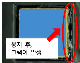
【기존의 석영 글라스 금 주석 봉지】 (크랙이 발생한 금 주석 봉지 후의 석영 글라스)
