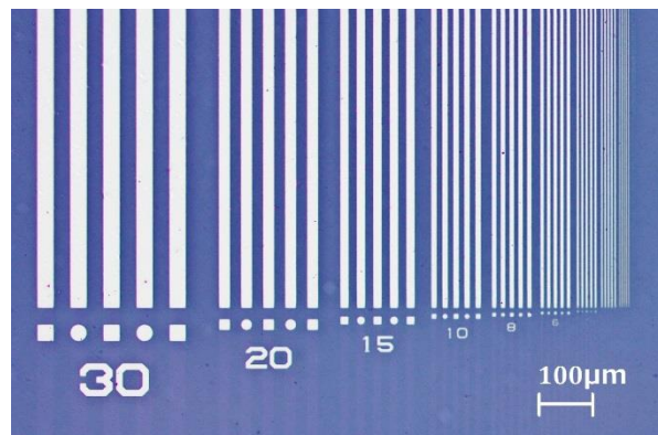
通过本技术形成的线宽 30~5 微米的配线
