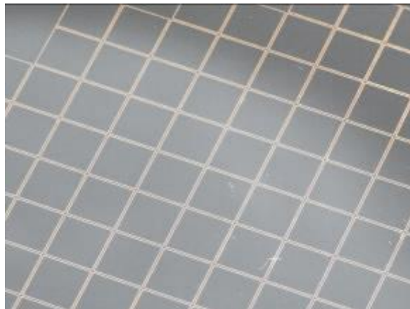
印刷於 8 吋晶圓基板之上「AuRoFUSE™」的密封外框外觀（200 微米寬）。
