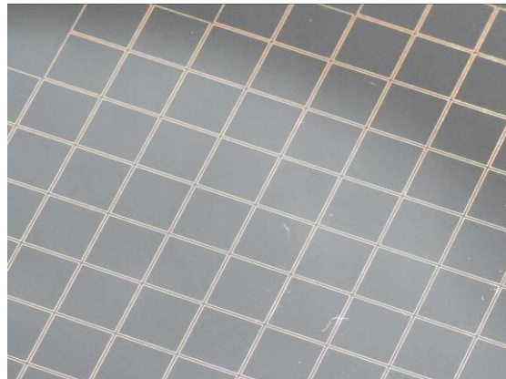
8인치 실리콘 웨이퍼 기판 상에 인쇄한 ‘AuRoFUSE™’의 봉지 프레임 외관(200 마이크로미터 폭)
