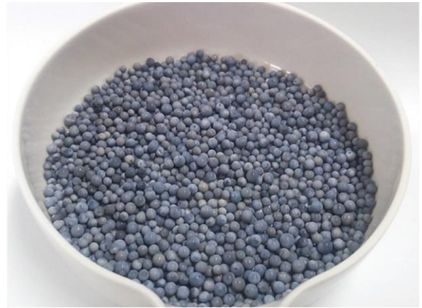
已開發的粒狀疎水性白金觸媒（粒徑 3mm）
